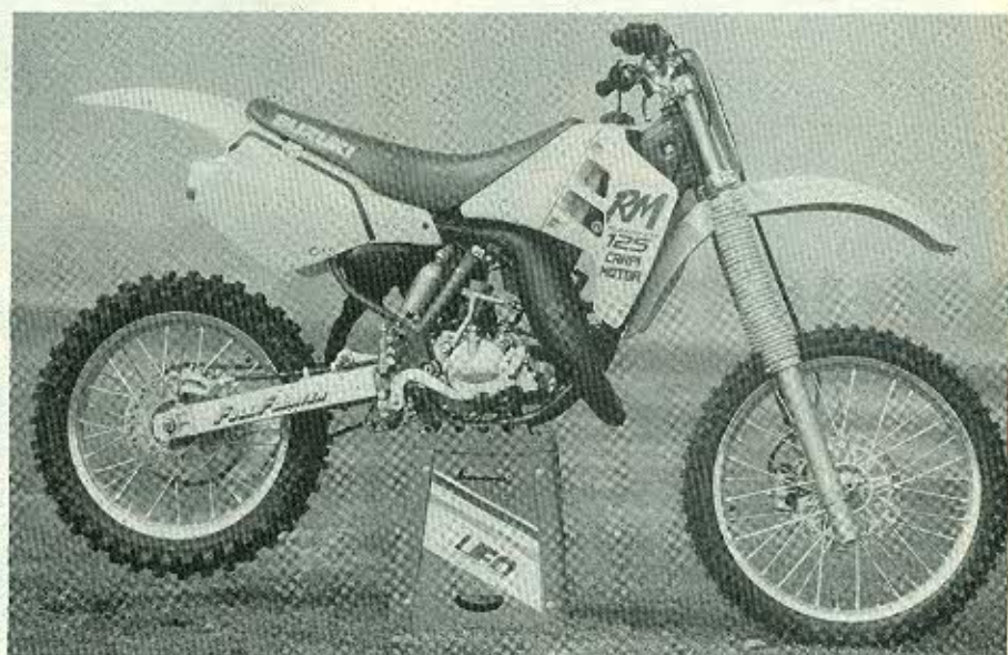
■ STUDIATO AL COMPUTER IL TELAIO DELLA RM 125 È IN TUBI D'ACCIAIO AL CR-MO. IL PROPULSORE EROGA OLTRE 31 CAVALLI ALLA RUOTA. LA SOSPENSIONE POSTERIORE È DEL TIPO FULL FLOATER E GARANTISCE ALLA RUOTA UN'ESCURSIONE DI 324 MILLIMETRI ■
