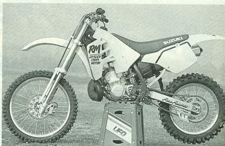
■ SULLA RM 250, CHE MONTA UN VIGOROSO MONOCILINDRICO DUE TEMPI CAPACE DI EROGARE OLTRE 46 CAVALLI ALLA RUOTA, SPICCA LA FORCELLA «UPSIDE DOWN» CON ESCURSIONE DI 310 MILLIMETRI. LA FRENATA È AFFIDATA A DUE DISCHI: L'ANTERIORE HA UN DIAMETRO DI 250 MM; 220 QUELLO DIETRO ■
