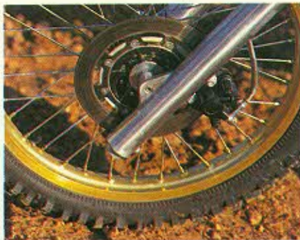
Le disque, qui fait sa première apparition sur la Kawa, est l'innovation technique de l'année en cross et c'est sans doute celle qui est promise au développement le plus spectaculaire. Pour le tout terrain, un diamètre plus réduit aurait sûrement été souhaitable.
