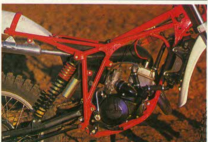
Avec Gilera, le distributeur rotatif fait un retour remarqué en moto cross. Comparée au Rotax, la pipe d'admission est plus grosse et plus courte et le carbu demeure très accessible. Noter également le cadre double berceau et le bras oscillant en acier.
