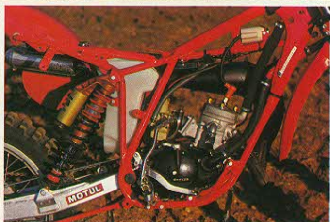
Pas de technique originale pour ce moteur qui trouve sa fantastique efficacité dans un dessin du pot et des transferts particulièrement bien étudiés.
