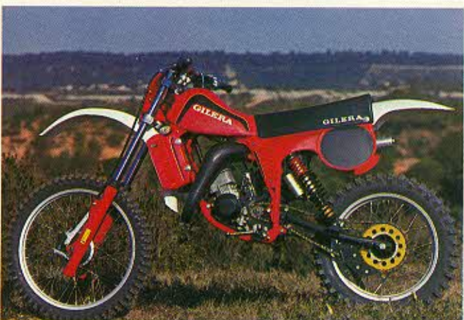
L'implantation du circuit de refroidissement de la Gilera rappelle un peu la Suzuki. Situé plus vers le haut, le radiateur laisse toutefois plus de place au pot moins encombrant latéralement.
