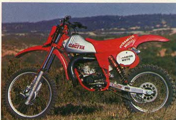
La selle artisanale montée sur la Caviga de notre essai démontre que pour obtenir un bon résultat comme sur la Yam, il faut prévoir le dessin du cadre et du réservoir en conséquence. Le moteur ne pêche guère que par l'éloignement de l'axe de sortie de boîte et du bras oscillant.
