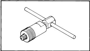
4. Rotor Puller P/N YM-01189 P/N 90890-01189
