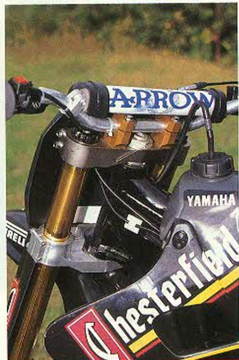
L'inévitable fourche Ohlins équipe la 125, comme la 250. Mais c'est le modèle 93 qui est utilisé sur la 125. Honnêtement, la différence est indécidable, tant le fonctionnement est exceptionnel...
