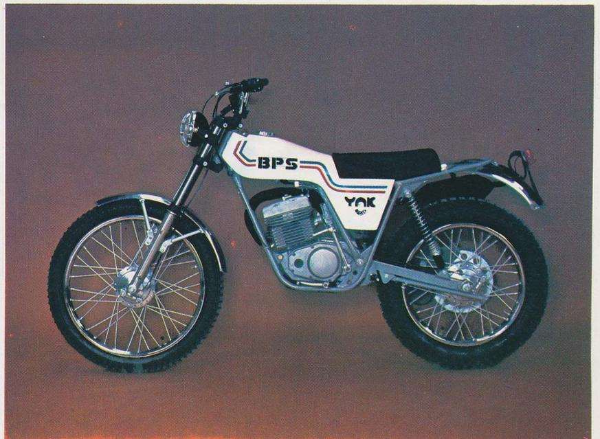
Monocylindre 2 temps - 125 cm<sup>3</sup> - 13 chevaux à 5600 t/mn - 5 vitesses - 82 kilos - prix 4.965,00 TTC (au 1-09-76)
