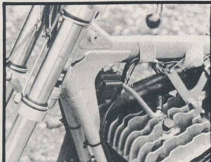
Tés de fourche plus larges, chasse diminuée et culasse toujours boulonnée au cadre.
