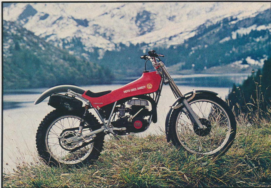
Cadre renforcé, nouvel échappement, nouveau bras oscillant, fourche plus large, et nombreuses modifications de détail. Principal regret : la couleur des garde-boue.
