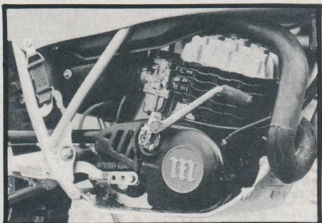
Modifications internes sur le moteur pour obtenir une meilleure régularité à bas régime, nouveaux réglages de carbu et nouvel échappement, plus long et plus volumineux, sans être gênant.
