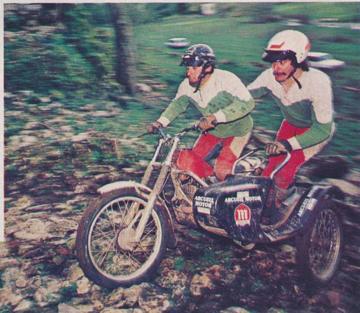
l'aile du panier sont en polyester ou en tôle légère, l'aile intégrant de plus une légère excroissance rembourrée (ou non) qui sert de selle pour le passager (ça, c'est pour le règlement, car de plus en plus, cette selle se retrouve être... l'aile elle-même). Le plancher est plat et le dessous du nez remonte vers l'avant, afin que le side puisse « glisser » sans se planter sur les obstacles.
