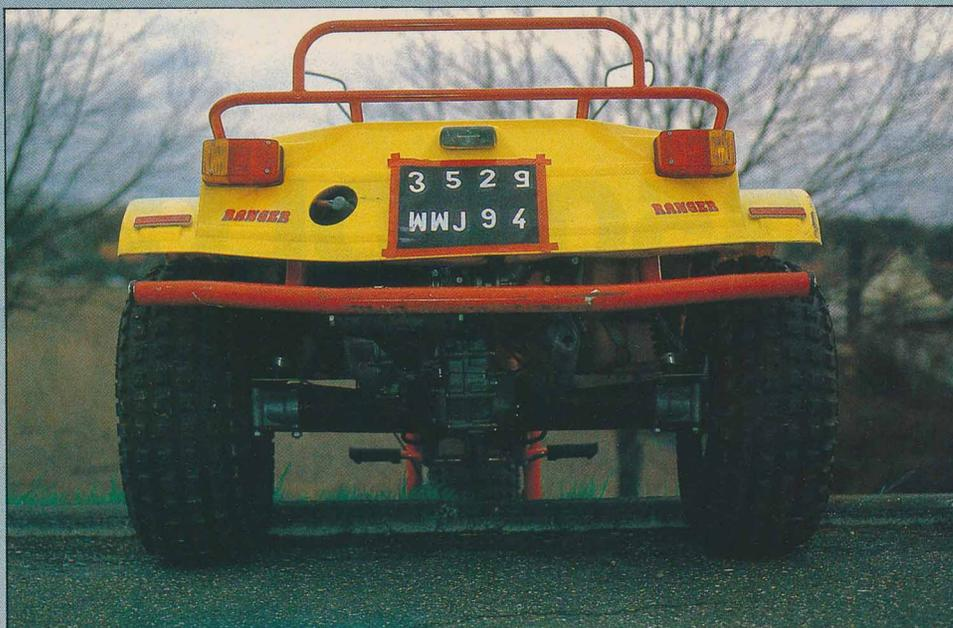
Vu de dos, le « Super-Ranger » ressemble plus à un Buggy qu'à un Trike. Il est presque aussi large que long, respectivement, 1 250 mm et 1 990 mm. Le poids à vide est de 160 kilos et, grâce au porte-bagages, vous pouvez emmener plus de 200 kilos. Les roues avant et arrière font 21 x 12-18.
