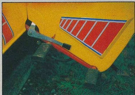
En haut : l'Italjet reprend le moteur et les suspensions du triporteur Piaggio et possède une boîte 4 vitesses à commande à main. Ce n'est pas le plus pratique mais ça marche depuis longtemps sur les scoot Vespa. Dans ce cas,
