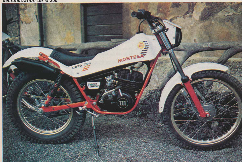
Cota 200 : partie-cycle conforme à la nouvelle 123, recherche de souplesse avant tout. Le résultat ? Apparemment très intéressant, d'après notre essayeur Manuel Soler !
