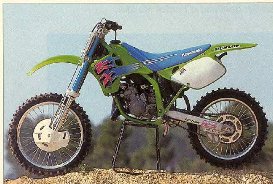
Cure d'amaigrissement au niveau des plastiques pour la KX 92, avec un original réservoir noir recouvert de gros panneaux constituant l'habillage. Cadre renforcé, empattement allongé et disque avant flottant sont aussi au programme. Côté moteur, un nouvel alésage/course "carré" et un plus gros carbu montrent que Kawa s'est sérieusement "bougé" sur sa 125 cette année.
