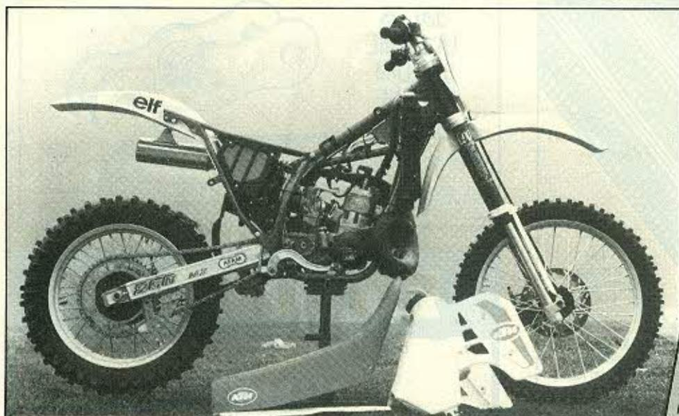
La bête démontée laisse apparaître un cadre plus petit, un grand radiateur côté droit, un pot littéralement plaqué contre le berceau et une homogénéité d'ensemble accrue.
