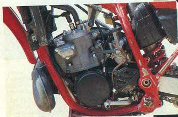
Le moteur bénéficie d'un volant allégé, de toutes nouvelles cotes et d'une boîte renforcée. Notez sur la photo de droite l'abaissement général du poids (pot, radiateurs) ; la suspension arrière est à présent cachée sous le bras oscillant caissonné d'alü.
