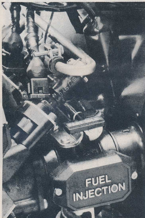
Par rapport à la 1000 H le système d'injecteurs est plus compact et moins lourd tout en offrant des possibilités plus importantes. A noter le nouveau filtre de décantation de plus grand diamètre.
