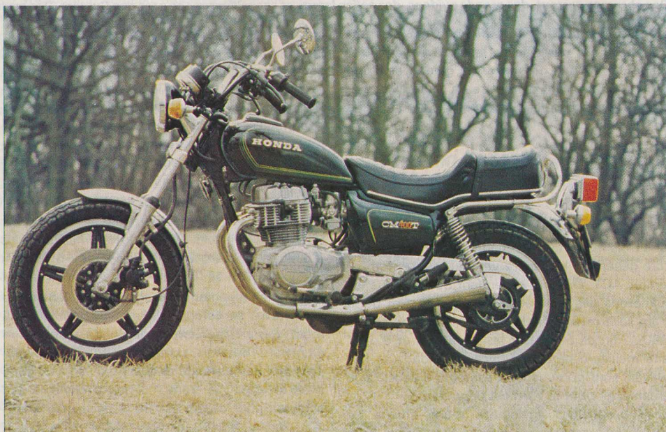
Un vrai fauteuil la CM 400 T. Et quel moteur ! Ni plus ni moins que celui de la fameuse CB 400 N du Challenge Honda. Seules différences, une boîte à 5 rapports au lieu de 6 et des carburateurs dont le diamètre de passage des gaz est ramené de 32 à 30 mm.
