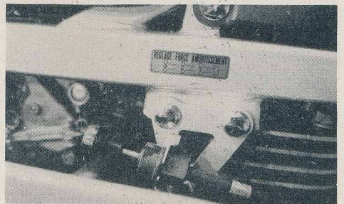
Un détail qui témoigne de la recherche en matière de facilité d'utilisation : le réglage en détente de l'amortisseur du Pro-link peut se manœuvrer en roulant puisque située juste sous le réservoir. Comme il en est de même pour la fourche avant, l'accord entre les deux s'effectue aisément.
