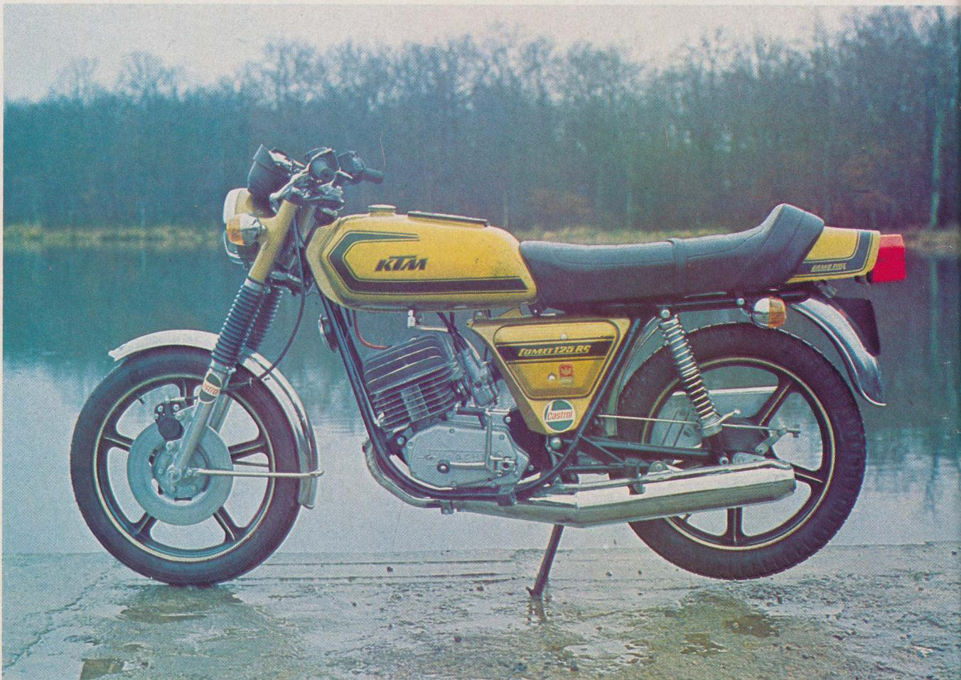
**Photos du haut : le frein arrière fait partie intégrante de la roue en magnésium. Les amortisseurs arrière sont très efficaces. Une fourche avant de premier ordre et un freinage hors pair sont des atouts de premier plan pour le KTM.**
