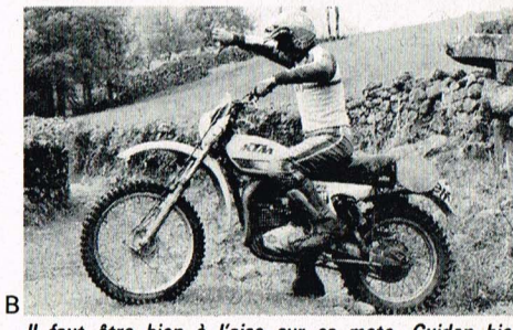
Il faut être bien à l'aise sur sa moto. Guidon bien positionné (A) et trop haut, erreur classique de débutant (B).
