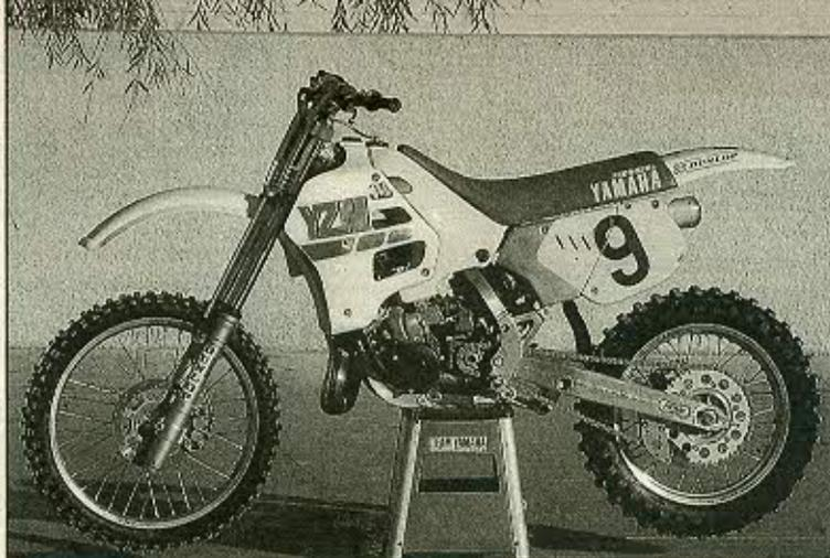
**Großflächige Kühlerverkleidungen prägen das Bild der Werks-Yamaha. Reichliche Materialzugabe im hochbelasteten Schwingebereich sichert die Festigkeit**
