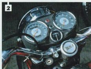
•1• Le trois-cylindres est alimenté par trois carburateurs Amal de 27 mm. •2• Changement d'époque oblige, les compteurs et compte-tours sont enserrés dans un bloc en plastique.
