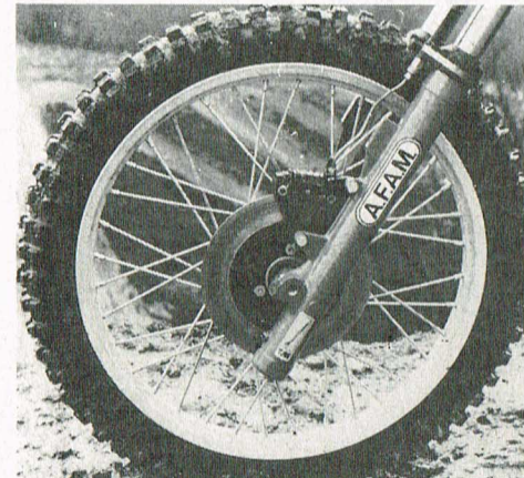
La KTM est la seule moto de la bande à posséder un frein à disque sur la roue avant.
