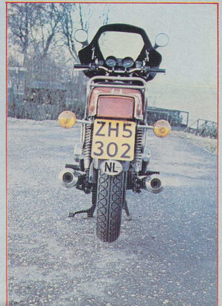
Het J. S. kuipje verbeterde de stroomlijn.
