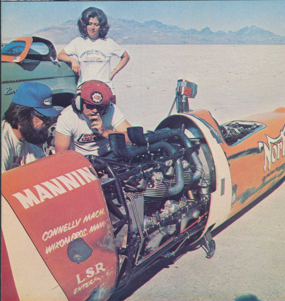
Le cigare Norton reçoit deux moteurs de Commando accouplés de façon classique. Norton a eu d'énormes problèmes avec la stabilité de l'engin ainsi qu'avec les moteurs.
