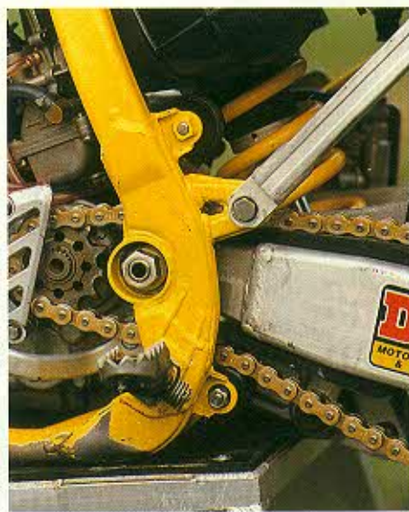
Nella zona delle pedane il telaio è formato da stampati in lamiera cui sono saldati i montanti, i rami della culla ed il supporto perno forcellone. La soluzione è stata riproposta pari pari per le macchine standard così come il montante reggisella in lega asportabile.
