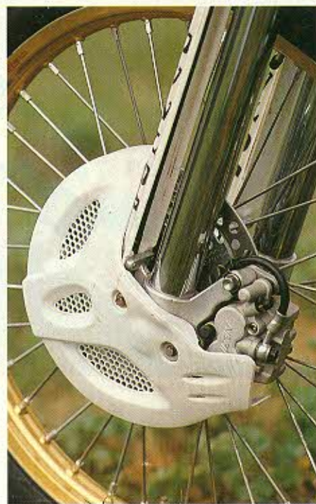
Prefigurazione 92 anche il copridisco, mentre le aste cromate della forcella sono protette solo nella parte anteriore. Il disco è un Nissin ufficiale da 250 mm con pinza a doppio pistoncino.
