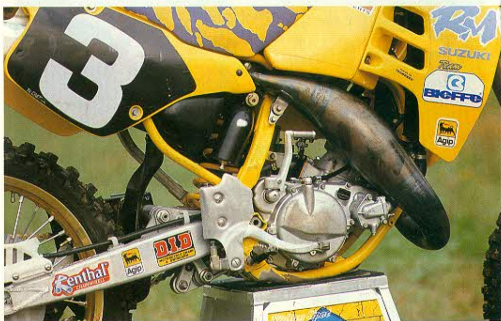
Primo piano dello specialissimo forcellone con bracci di forza a sezione variabile e del propulsore lamellare ad alimentazione nel carter. L'espansione, a sviluppo obliquo con terminale alto come sulle RM di serie, è diversa nella zona di collegamento col silenziatore, il monoammortizzatore è uno Showa ufficiale montato su leveraggio progressivo Full Floater.
