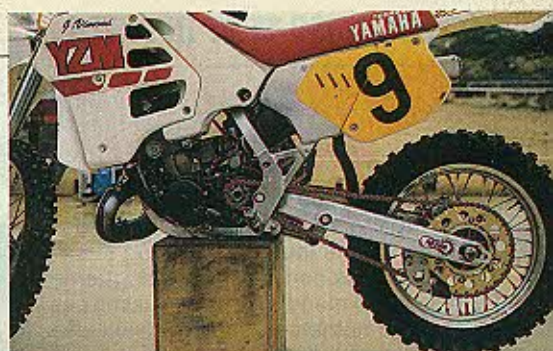
Poco visibile il motore dal lato sinistro, in gran parte coperto dal serbatoio che scende fin quasi al livello della vaschetta del carburatore.
