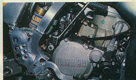
Primo piano del motore in cui spicca, sulla destra, il leverismo (parzialmente visibile nel tubetto di protezione trasparente) e il grosso alloggiamento del pacco lamellare alla cui estremità è fissato elasticamente un carburatore Mikuni da 38 mm.
