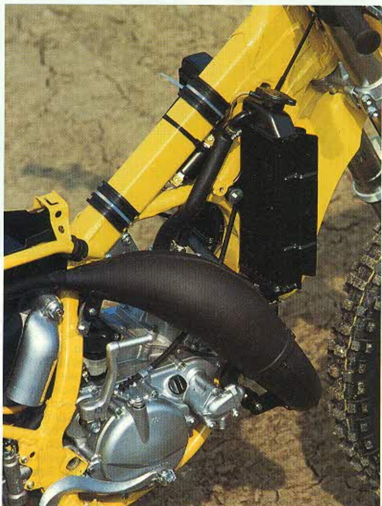
Sopra, il motore della 250 è stato rivisto nella parte termica e nell'albero motore per migliorare l'erogazione ai bassi e medi regimi. Sotto, il massiccio telaio della 125 rinnovato nella forma e nelle dimensioni.
