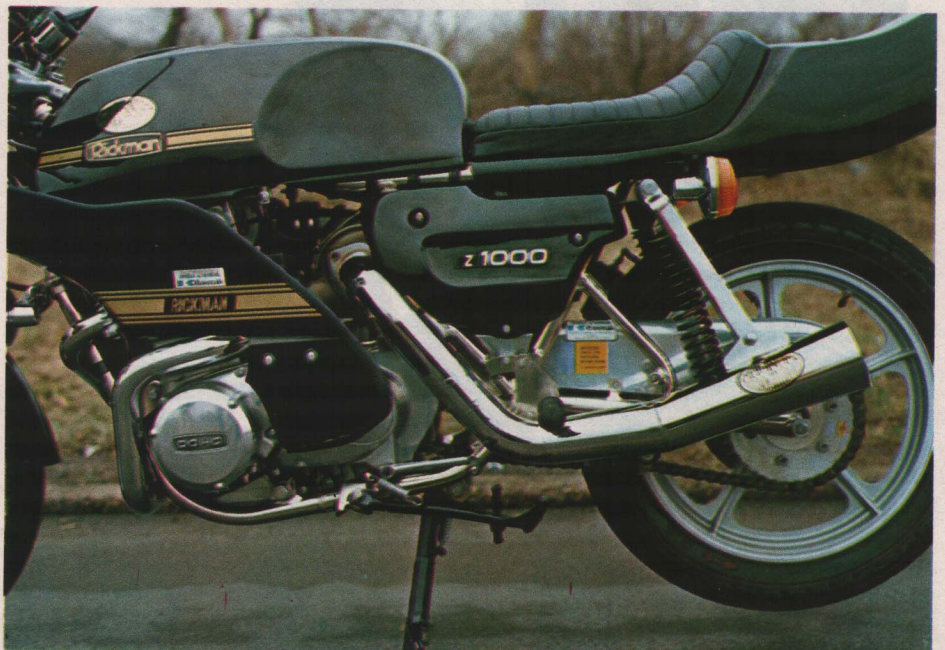
2. Cette Kawa-Rickman, mieux que sur les japonaises où le compresseur est souvent dissimulé, montre bien le turbo qui fait une dérivation dans le circuit d'échappement, où il pique l'énergie pour faire tourner ses turbines.
