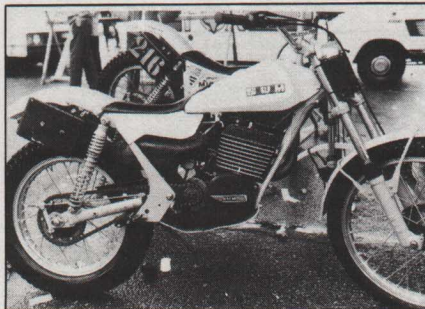
Le prototype 350 cm 3 S.W.M. : ce modèle pourrait être produit en 1983. A noter que l'admission est mixte : clapets et jupe du piston.
