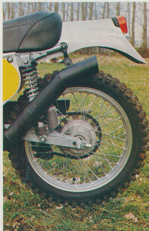
Comme sur les « grosses » BPS, le pot passe sous le moteur, pour se relever ensuite : il est quelque peu gênant pour le kick.
