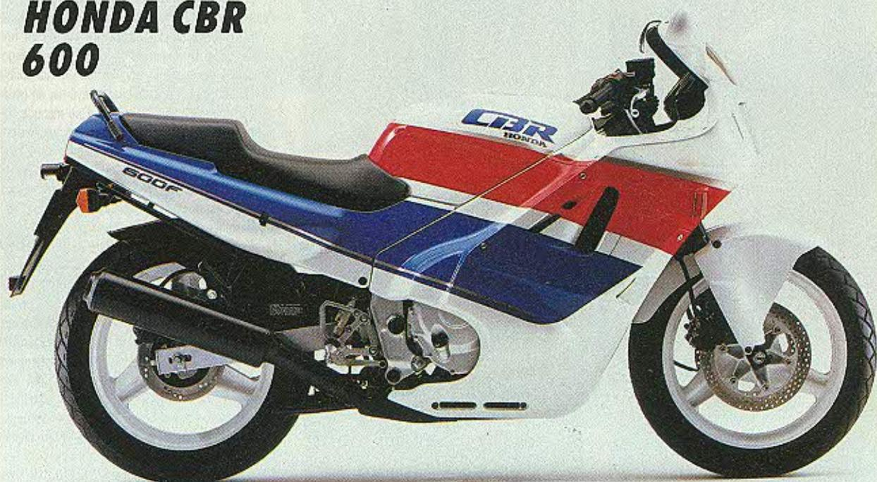
*Déjà très performante, la CBR 600 gagne pas moins de 8 canassons, sa puissance passant de 85 à 93 chevaux au même régime de 11.000 tours. Une progression sensible obtenue grâce à un ensemble de modifications sur le rapport volumétrique, les conduits d'admission, les arbres à cames etc. Des mesures qui, avec de nouveaux coloris, vont permettre à la Honda d'entrer sereinement dans sa troisième année.*
