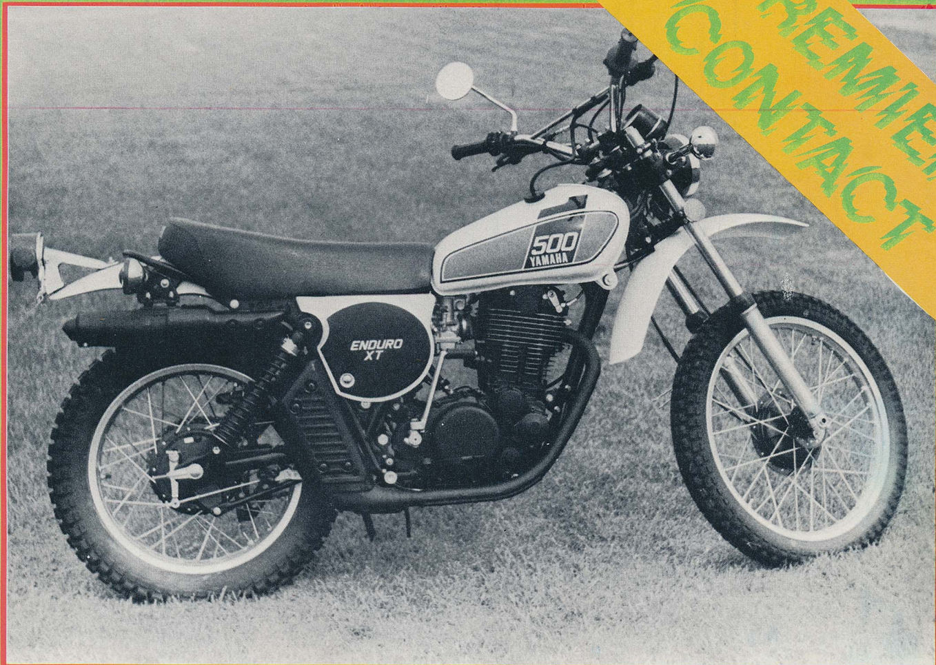
La XT version trail bike possède un volumineux feu arrière, un silencieux plus important que celui de la TT, un phare avant, des clignotants à l'avant comme à l'arrière et un rétroviseur. Mais la ligne générale est la même. Les moyeux de roues sont plus petits (comparez avec la photo de la TT). Les deux machines possèdent le même garde-boue avant en plastique souple. Le réservoir possède un tuyau de trop-plein ; le remplissage d'huile se fait par un bouchon situé sur le haut du cadre entre la colonne de direction et le réservoir d'essence.
