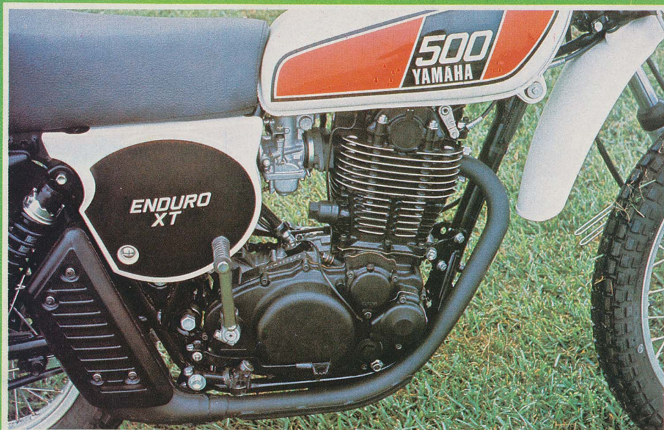
Le moteur de la 500 Yam est peint en noir mat : en haut à droite, sur la culasse, le levier actionnant le décompresseur. Juste en dessous du carburateur, le petit ergot est le réglage de la tension de la chaîne d'arbre à cames. Le carter en magnésium épouse les formes des organes moteur : le gros rond cache l'embrayage, les petits ronds les rupteurs et le filtre à huile.
