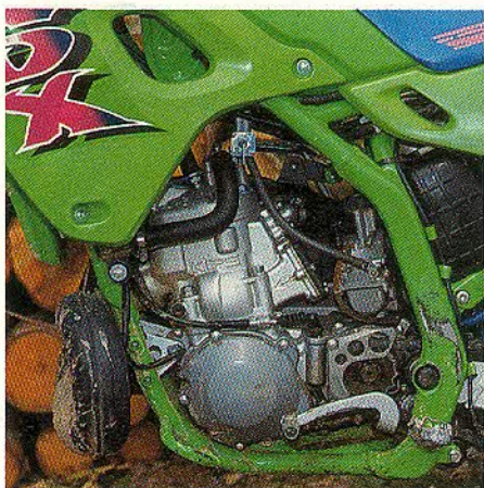
Cadre périmétrique et moteur d'origine KX, le choix est pour le moins judicieux et permet à la 250 KDX de prétendre au scratch à l'occasion de n'importe quel enduro "initiation".
