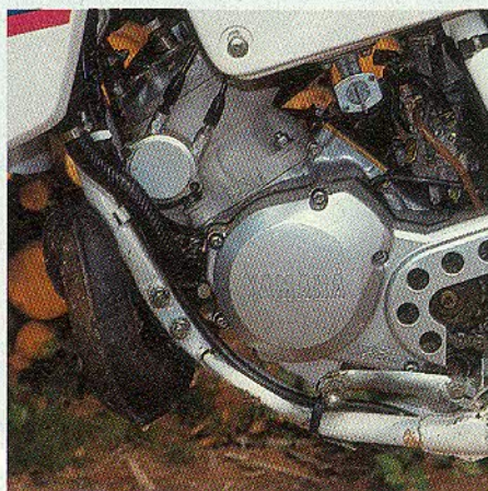
Le moteur de la WR est compact, léger et développe 34,4 ch à 9 000 tr/mn. Le cadre est proche de celui de l'YZ.
