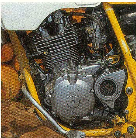
Culasse TSCC à double dôme quatre soupapes, carbu Mikuni de 33 mm à boisseau en demi-lune, balancier d'équilibrage, etc... le moteur de la DRS a plus d'un tour dans son monocylindre.
