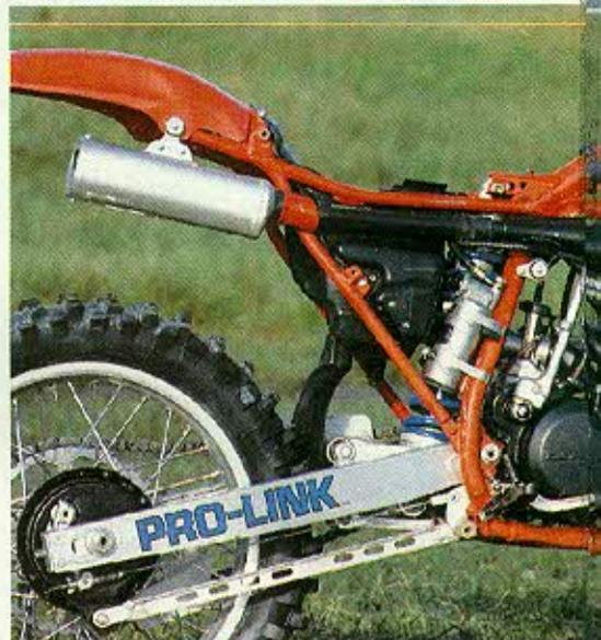
Imparentata da vicino con la CR 125, la quarto di litro Honda ha entusiasmato i collaudatori per la notevolissima agilità con la quale si lascia condurre, accoppiata alle doti di un propulsore potente e sfruttabile. Il telaio, in alto, ha la parte posteriore smontabile
