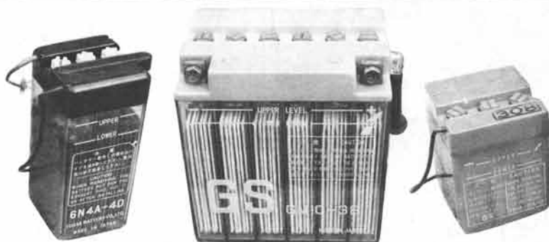
各種のバイク用バッテリー(新旧)。左右は6V、中央が12Vで、バイクでは始動がセル式のものすべて12Vバッテリーを使用。
